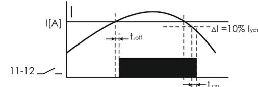
При превышении установленного значения тока [A] реле переключается через время задержки отключения t[s] (контакты 11-12 замыкаются, контакты 10-11 размыкаются). При снижении величины тока (с учетом гистерезиса ΔI) реле возвращается в исходное состояние через время повторного включения t.on (контакты 11-12 размыкаются, 10-11 замыкаются).
