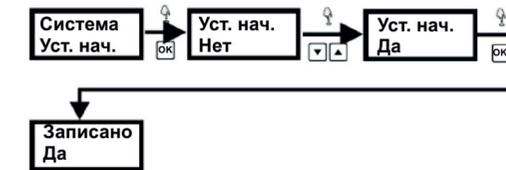
После подтверждения происходит возврат к заводским настройкам регулятора со следующими установленными параметрами:
