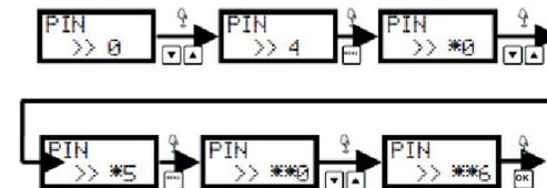
PIN-код вводится только один раз в течении всего времени режима редактирования настроек. при выходе из режима редактирования CRT-06 около 10 секунд остается в состоянии отключенной защиты (о чем свидетельствует мигающий ключевой символ на дисплее). В течение этого времени вы можете повторно перейти в режим редактирования (кнопка «Меню») без необходимости повторного введения PIN-кода.
