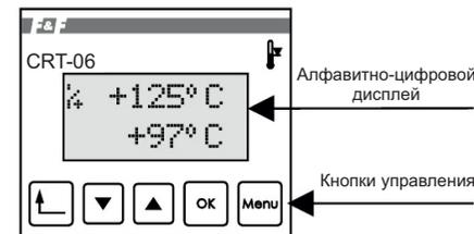
В нормальном режиме работы на дисплее регулятора температуры отображается значение температур измеряемых датчиками C1 (верхняя строка) и C2 (нижняя строка). Если к регулятору подключен только один датчик температуры, то отображается, только измеряемое им значение температуры (верхняя строка).
