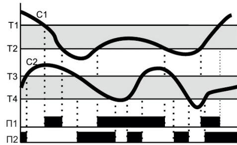
Если измеряемая датчиком C1 температура находится в пределах параметров T1 и T2, то контакт реле П1 замкнут. Аналогично, если измеряемая датчиком C2 температура находится в пределах параметров T3 и T4, то контакт реле П2 замкнут.
