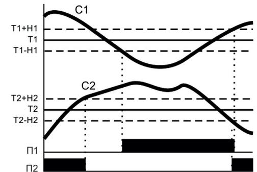
Если температура датчика C1 падает ниже значения (T1-N1), то замыкается контакт реле П1. Когда температура возрастает до значения (T1+N1), то контакт размыкается. Аналогично для датчика C2, если температура падает ниже значения (T2-N2), то замыкается контакт реле П2 и когда температура возрастает до значения (T2+N2), то контакт размыкается.
