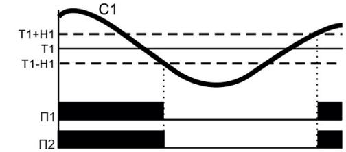
Реле П1 и П2 работают параллельно и при повышении температуры выше значения (T1+H1) включается режим охлаждения и контакты реле замыкаются. Режим охлаждения выключается при понижении температуры до значения (T1-H1), при этом контакты реле размыкаются.
