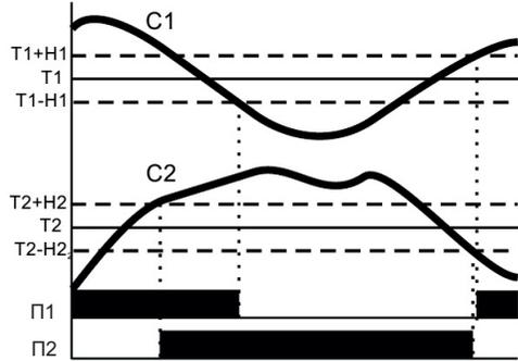
Если температура датчика C1 поднимется выше значения (T1+N1), то замыкается контакт реле П1. Когда температура падает до значения (T1-N1), то контакт размыкается. Аналогично для датчика C2, если температура поднимется выше значения (T2+N2), то замыкается контакт реле П2 и когда температура падает до значения (T2-N2), то контакт размыкается.
