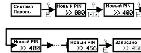
При работе в режиме с паролем при нажатии кнопки «Меню» нужно ввести PIN-код.
