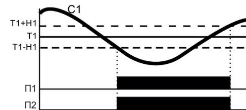
Если температура измеряемая датчиком C1 становится ниже значения (T1-H1), то контакты реле П1 и П2 замыкаются. Контакты реле снова размыкаются при возрастании температуры до значения (T1+H1).
