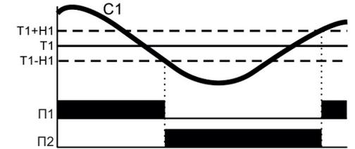
Реле П1 и П2 работают попеременно. Реле П1 работает в режиме охлаждения, при этом контакт реле замыкается при повышении температуры выше значения (T1+H1), и размыкается при понижении температуры ниже (T1-H1). Реле П2 работает в режиме нагрева, при этом контакт реле замыкается при понижении температуры до значения (T1-H1), и размыкается при повышении температуры до (T1+H1).
