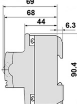
Устройство Защитного Отключения
