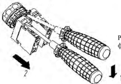
Рис. 12 Демонтаж контактного узла
