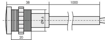
Фотодатчик – герметичный внешний фотоэлемент, присоединяемый проводом. Если длина провода более 10 метров, то он не должен располагаться ближе 50 см к параллельно проложенным сетевым или высоковольтным проводам. Допускается увеличение длины фотодатчика до 50 метров.
