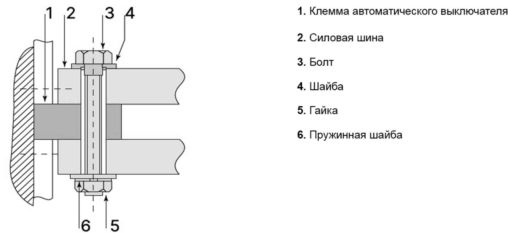
Рисунок 1. Схема зажима силовой шины
